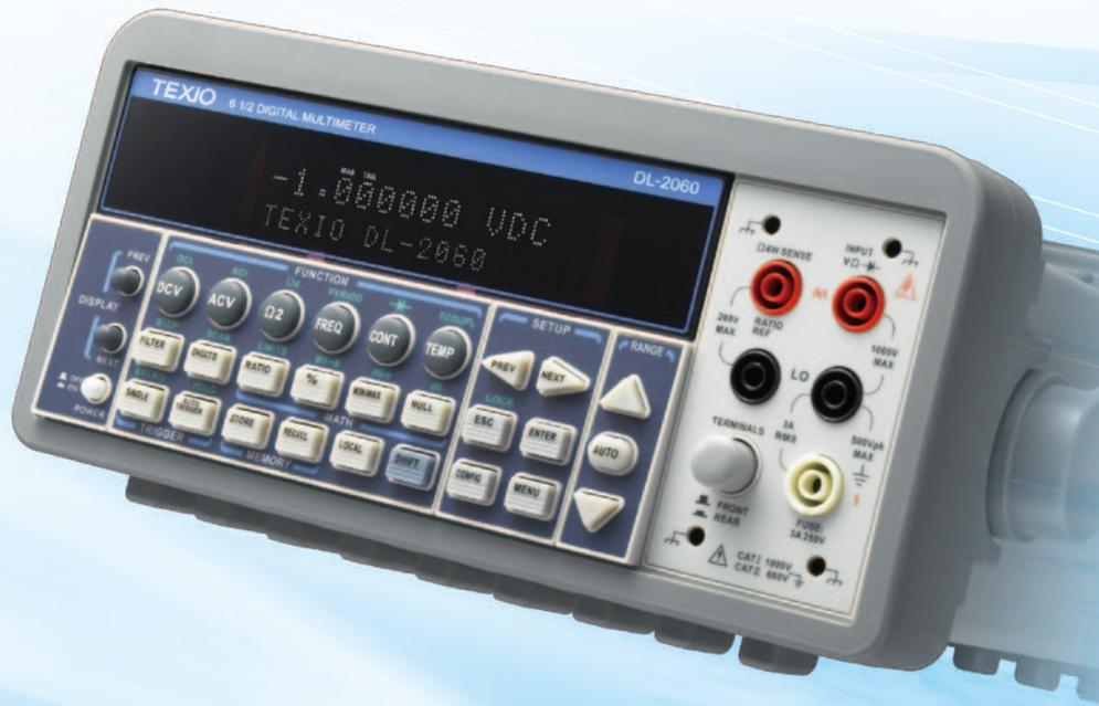
DL-2060/DL-2060Gは、1199999カウントの高分解能、6・1/2桁デジタルマルチメータです。表示部にはVFD（蛍光表示管）を採用し、3色カラー表示ディスプレイにより優れた視認性を実現しています。測定スピードは分解能6・1/2桁で最高50回/秒、分解能4・1/2桁で最高2000回/秒の高速測定が可能です。測定機能は電圧、電流、抵抗、温度、周波数など12種類で、さらに8種類の演算機能もあわせることで、より効率的な測定が可能です。またオプションで装着可能なマルチポイントスキャナカードを使用することで、最大10チャンネルの入力信号を自動的に切替えて計測することができます。標準装備のUSBインタフェースやGP-IB（Gタイプのみ）により、データの転送や制御が行なえます。開発・設計だけではなく生産・教育現場においてもご使用いただける製品です。
