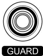
GUARD 端子は、アースと同じ電位をですが、その代わりにすることができません。ノイズを軽減するために、テストリードのシールドをガード端子を接続します。
