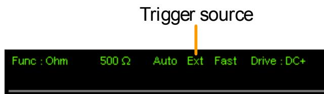
2. 手動トリガ測定 **(Trigger)** を短押しする度に一度(シングル)測定をすること
