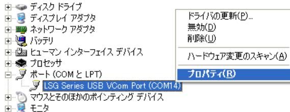
ボーレート、ストップビットおよびパリティ設定は右クリックで接続されたデバイスのプロパティを開き、ポートの設定で選択することができます。COM ポートの変更は詳細設定で行います。
