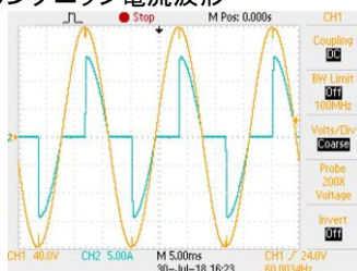
90° SCR リーディングエッジ電流波形
