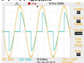
90° SCR リーディングエッジ電流波形
