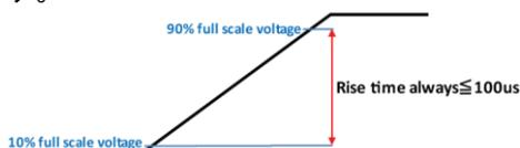
Slope 立ち上がりスルーレートは  $1.5\text{V}/\mu\text{s}$  に固定されており、出力電圧スケールの違いに応じて立ち上がり時間が変わります。
