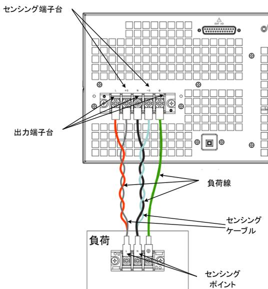
4. 接続後、保護カバーをセンシング端子台に被せます。
