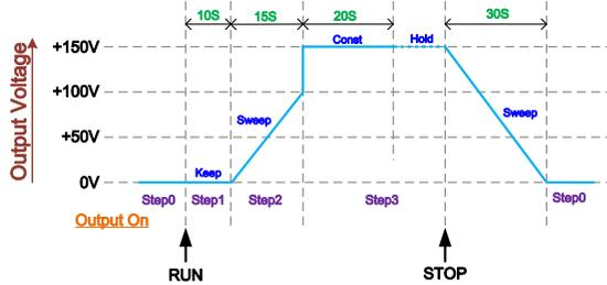
上記の例は、二次(遷移)特性が各ステップでの電圧の出力にどのように関連するかを示しています。
