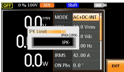
3. ツマミまたは F3(MAX)と F4(MIN)のソフトキーを使ってピーク電流 (IPK +と IPK-)を設定します。
