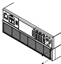
4. プラスチックフレームを矢印で示された方向に動かします。
