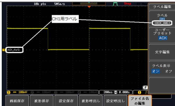
上記の例では、チャンネル1のラベルは、チャンネルインジケータの隣に表示されていて、保存波形メニューにも表示されます。Ref\_1のラベルは、リファレンスインジケータの隣に表示されています。
