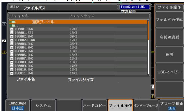
4. **VARIABLE** ツマミを回しファイルカーソルを上下に移動させます。イメージファイルは自動的にプレビューが動作します。*Select* キーでファイルやディレクトリの選択やファイルパスを設定します。
