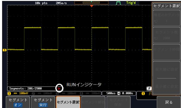
5. セグメントの取得が完了したら画面下のセグメント停止キーを押してください。
