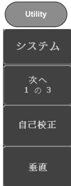
6. 画面にメッセージ “Now performing vertical calibration...Set CAL to the channel, then press the Vertical key” が表示されます。
