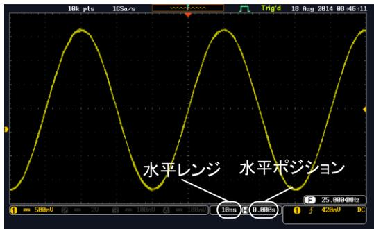
Run モード Run モードでは、波形サイズとメモリバーは、その比率を維持します。水平時間を遅くするとロールモードになります。(トリガモードがオートの場合)
