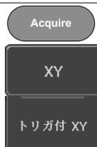
X-Yモードは、上下2画面に分割します。画面上部は、全体波形を表示します。画面下部は、X-Yモードを表示します。
