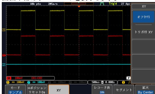
X-Y波形のポジションを移動するには、垂直ポジションツマミを使用します:チャンネル1のツマミはX-Y波形を水平方向に移動し、チャンネル2のツマミはX-Y波形を垂直方向に移動します。同様に、X2とY2軸はチャンネル3とチャンネル4のポジションツマミで移動できます。
