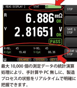
最大 10,000 個の測定データの統計演算処理により、手計算や PC 無しに、製造プロセスの状態をリアルタイムで明確に把握できます。
