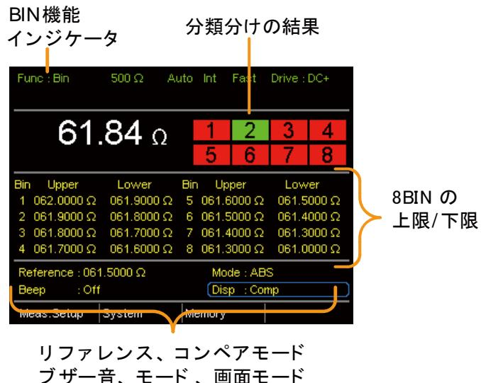
1. Bin 機能の選択 **Binning** キーを押し BIN 機能を選択します。
