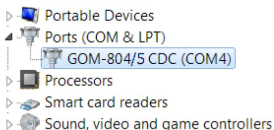
USB を使用する場合は、ボーレート、ストップビット、パリティ設定は、接続されたデバイスを選択し右クリックしてプロパティオプションを選択することで閲覧できます。
