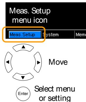
2. 周囲温度設定の表示 矢印キーで Ambient Temperature(温度単位)を設定します。Enter キーで設定を確定します。
