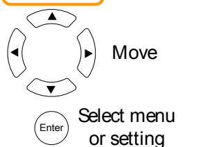
2. 測定遅延時間の 矢印キーで Measure Delay をオンに遅延時間を設定します。Enter キーで設定を確定します。
