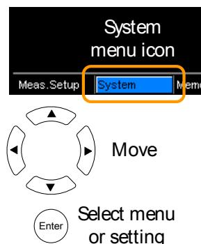
2. インターフェース 矢印キーでインターフェースの種類を選択しボーレート、設定を表示 EOL(RS-232C)または GP-IB アドレス(GPIB)を選択します。Enter キーを押し、設定を確定します。
