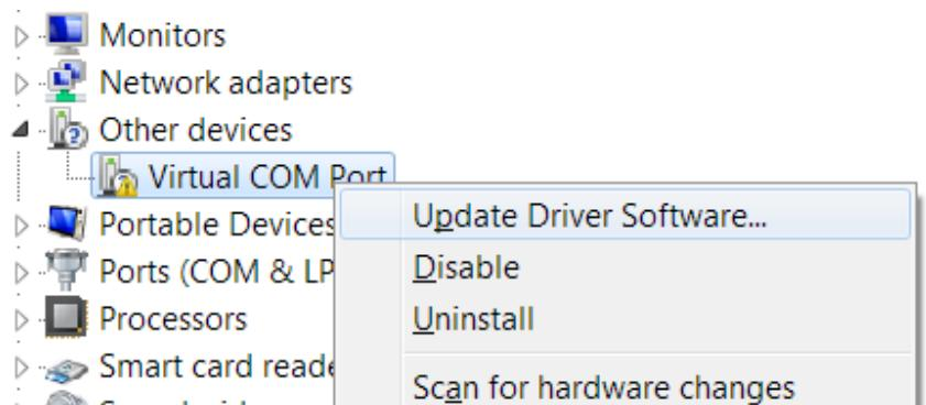
その他のデバイス上で右クリックしドライバソフトウェアの更新を選択します。
