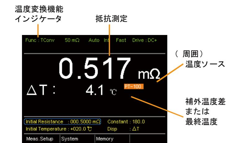
2. 内部抵抗、内部温度と定数の設定 矢印キーで Initial Resistance、Initial Temperature または Constant((推測初期抵抗温度)へ移動し Enter キーを押します。
