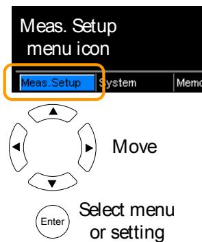
2. 商用周波数設定の表示 矢印キーで商用周波数を設定します。Enter キーで設定を確定します。
