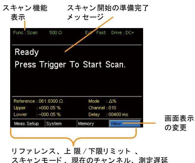
1. スキャン機能を選択します 上記のように **Scan** キーを押すスキャンモードにアクセスします。
