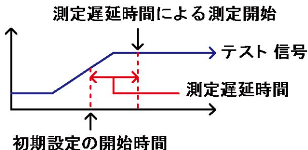
測度遅延時間を設定すると、初期設定の測定開始時間が最適ではない充電に時間を必要とするような部品を測定するのに有効です。
