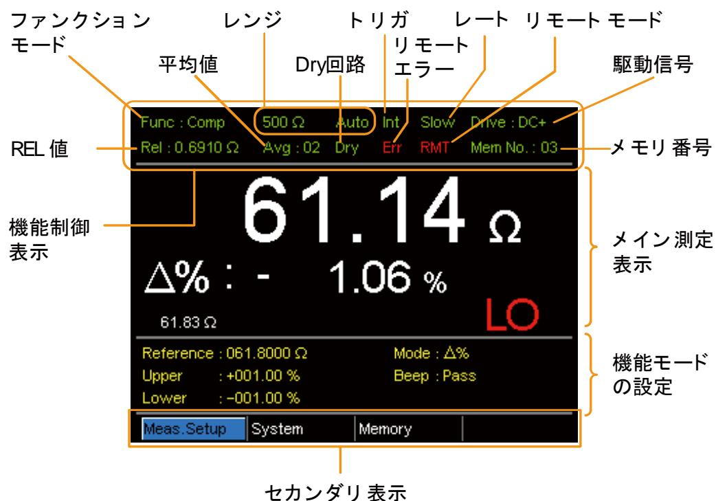
**ファンクション制御インジケータ** 機能制御インジケータは、選択しているファンクションモードの現在有効な設定を表示しています。
