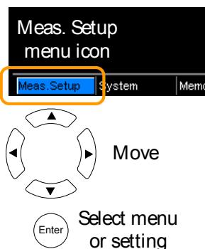
Meas. Setup へ移動し、Enter キーを押します。
