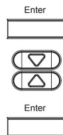
8. 矢印キーで SetTime の桁を指定し、Enter キーで変更モードに入ります。矢印キーですべての桁を設定し、Enter キーで確定します。
