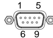
**PC と GOM を RS-232C で接続する** RS-232C の接続は、(TxD)送信および受信(RxD)ラインがクロスされているケーブル、またはインターリンクケーブルを使用します。
