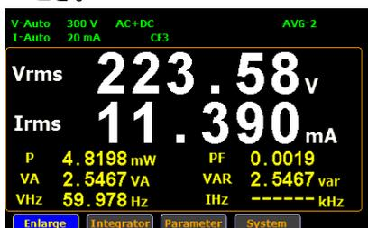
電流レンジが20mAなので、入力電流が22mAを超えると50mAレンジになります。
