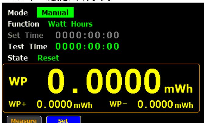
5. **Enter** キーでモード設定に入ります。Manual モードは手動で測定を終了します。Standard モードは測定時間を設定し、自動で測定を終了します。上下の矢印キーで切り替えて、**Enter** キーを押します。Manual モードでは Set Time はグレー表示になります。
