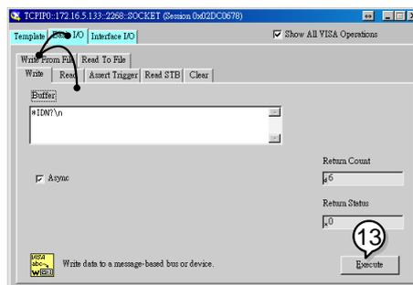
14. Basic I/O > Read タブ選択し、\*IDN?クエリーの返信を確認します。正しく通信可能ならば、下記のような、パラメータが表示されます。GWINSTEK,GPM-8213,RNXXXXXXXXX,V1.00.
