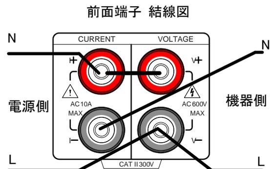
・AC 高電圧測定 (PT および CT 利用時)
