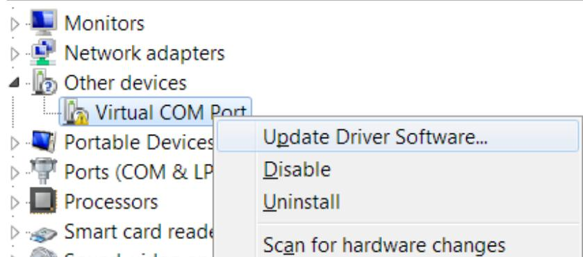
その他のデバイス上で右クリックしドライバソフトウェアの更新を選択します。
