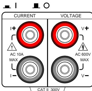
電流+, 電流-, 電圧+, 電圧-の端子です、背面の入力端子とつながっています。
