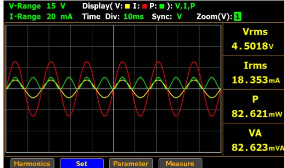
11. **Enter** キーを押して、**Zoom(V)**フィールドに入ります。上下矢印キーを使用して設定を切り替えます。**Enter** キーを押して設定を決定します。
