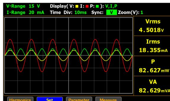
9. **Enter** キーを押して、**Sync** フィールドに入ります。上下矢印キーを使用して設定を切り替えます。**Enter** キーを押して設定を決定します。
