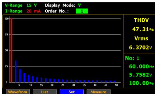
8. **Enter** キーを押して **Order No.** へ入り、上下矢印キーで設定を切替え、**Enter** キーで決定します。
