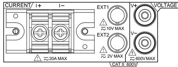
電圧用/電流用の入力端子です。測定用のケーブルを接続します。
