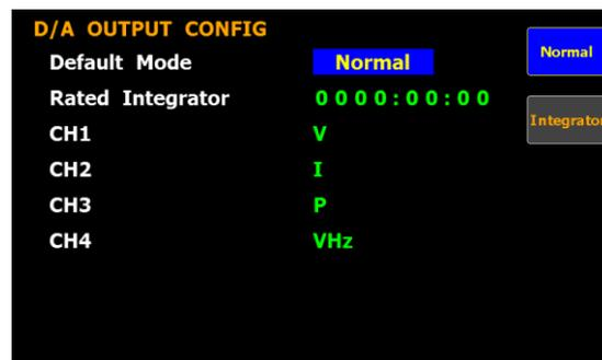
**選択**      **Normal**      The D/A 出力 Normal モードの各チャンネルの出力パラメータは下記の初期値に設定されます。
