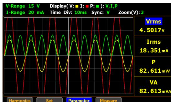
6. 下矢印キーで、カーソルを 2 段目のパラメータに移動し、1 段目と同様に設定します。操作を繰り返し 3 段目 4 段目も設定します。
