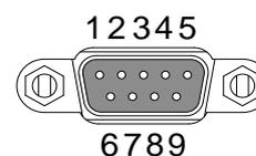
PC 接続 TxD と RxD ラインがクロスしているケーブル、またはインターリンクケーブルを使用します。
