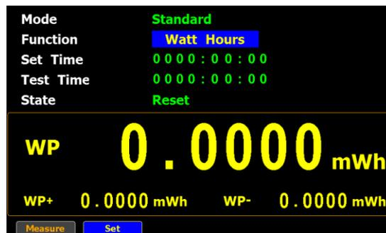
積算パラメータの選択 8. 下矢印キーを押し、測定値が表示される下半分のセクションに移動します。
