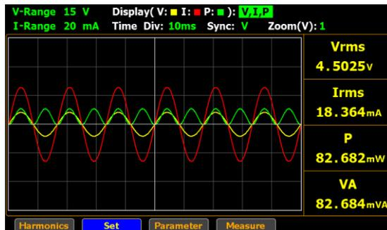
5. **Enter** キーを押して、**Display** フィールドに入ります。上下矢印キーを使用してウェーブフォームの表示項目(**V,I,P**)を切り替えます。**Enter** キーを押して、項目を決定します。
