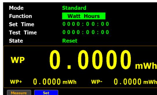
7. **Enter** キーを押して **Function** フィールドへ入ります。上下矢印キーを使い **Ampere Hours** と **Watt Hours** を切り替え、**Enter** キーを押して決定します。
