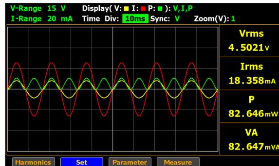
7. **Enter** キーを押して、**Time Div** フィールドに入ります。上下矢印キーを使用して設定を切り替えます。**Enter** キーを押して設定を決定します。
