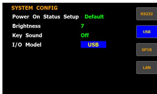
**GPIB** インターフェースに GPIB が選択されている場合、**GPIB Address** の 1 ~ 30 が選択可能になります。詳細はページ 110を参照ください。
