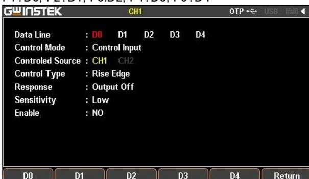
F2 キー Enable F2 キー(Enable)を押して、選択したデータラインによる動作を有効とするか、無効とするかを設定します。モードの設定は Enable NO で行い、動作時に Enable Yes とします。
