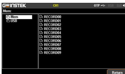
1. 内部メモリ 右矢印キーを押して、画面右側の 10 個のファイルが表示されている側に入ってください。エンコーダを回して、保存先のファイルを選択します。必要であれば、エンコーダを回して
