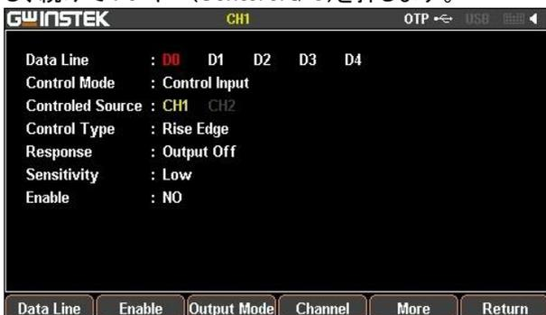
F1 キー Data Line F1 キー(Data Line)を押して、D0~D4 の中から使用する信号線を選択します。
