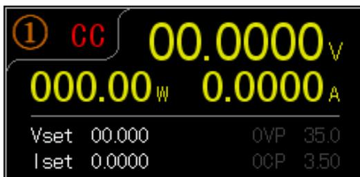
**概要** 本機に搭載されている各チャンネルは、電源として動作させることが可能です。チャンネルごとに電圧・電流の設定値・読み取り値を表示させることが可能で、出力状態の表示も可能です
