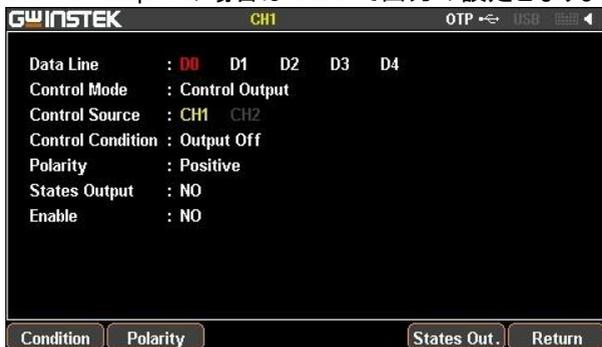
Polarity で出力極性、StatusOut.で出力の ON・OFF を指定します。キーを押すたびに状態がトグル動作します。Condition は条件の設定に移行します。
