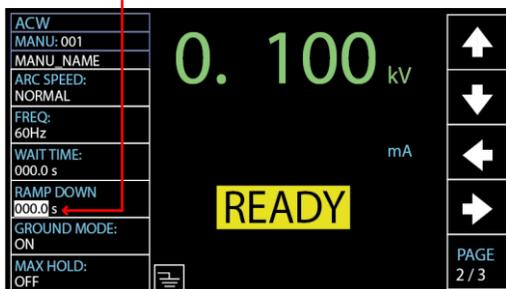
3. ロータリノブを回して下降時間(RAMP DOWN)を設定します。
