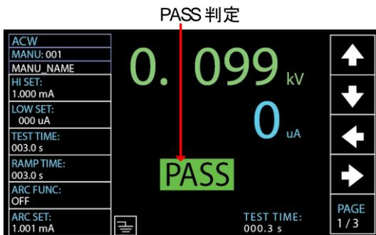
2. PASS と判定されると、本器はただちに READY(準備完了)の状態に戻ります。ただし、PASS HOLD の設定が有効になっている場合は、PASS HOLD の設定時間が経過するまでは PASS 判定の状態が続きます。詳細については、59 ページを参照してください。
