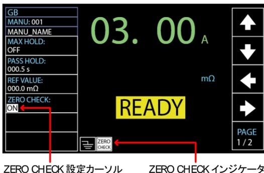
4. START ボタンを押して ZERO CHECK を実行します。ZERO CHECK 完了後の測定抵抗値は、下図のように REF VALUE の欄に加わります。
