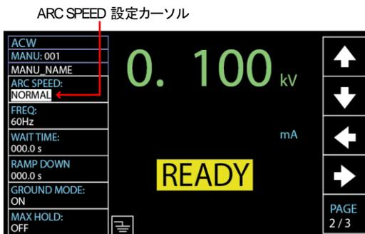
7. ロータリノブを回して ARC SPEED のレベルを設定します。
