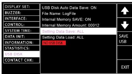
8. 上/下矢印ソフトキーを押して、カーソルを設定データのロード設定に移動します。MANUDATA、AUTODATA、SYSDATA またはすべてのデータを USB ディスクからロードできます。
