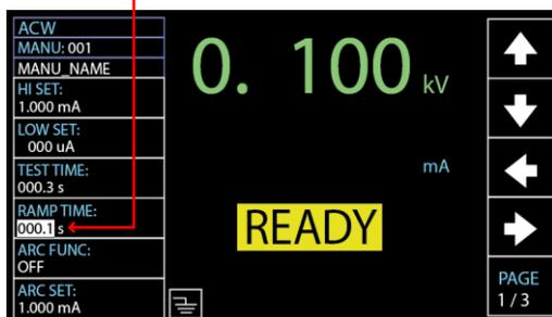
2. ロータリノブを回して上昇時間(RAMP TIME)を設定します。
