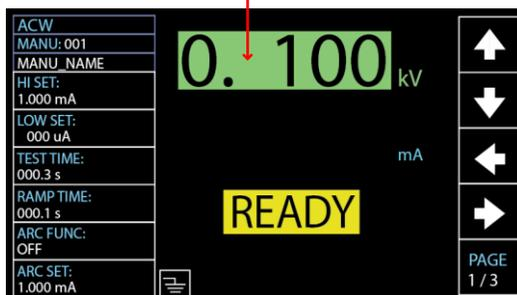
2. ロータリノブを回して試験電圧または試験電流を設定します。
