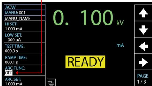
2. ロータリノブを回して ARC 機能を設定します。
