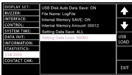
USB LOAD ソフトキーを押して、選択したデータを USB ディスクからロードします。
