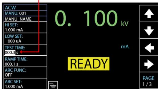
2. ロータリノブを回して試験時間(TEST TIME)を設定します。
