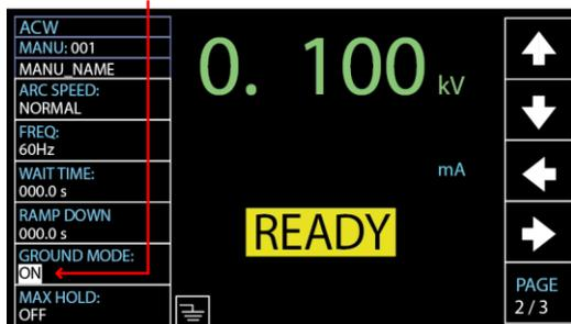
3. ロータリノブを回して GROUND MODE を設定します。
