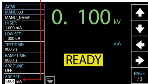
4. ロータリノブを回して ARC SET のレベルを設定します。
