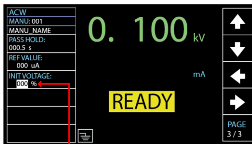
INIT VOLTAGE 設定カーソル
