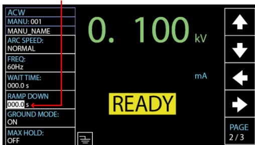
RAMP DOWN カーソル
