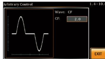
コンデンサ入力による整流フィルタ電流波形をシミュレート
