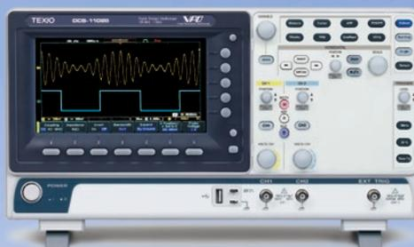
DCS-1000B シリーズは、クラスを超えた高性能と豊富な機能と7インチ WVGA の大型ワイド画面に最大 10M ポイント/CH の大容量波形メモリと最高 1GS/s の 4CH/2CH デジタルストレージオシロスコープです。波形更新レートが最高 50,000 波形/秒の VPO テクノロジーと 256 階調表示により発生頻度の少ない現象でも明瞭に観測できます。さらに、大容量 10M ポイント/CH の波形メモリにより低速掃引でも詳細な波形を表示できます。さらに、フリーアプリケーションを追加することでデジタルフィルタ機能、データログ機能を追加できます。また、オプションでセグメント機能、シリアルバストリガ・デコード機能※、波形サーチ機能と 3 種類の上位クラスと同等の波形解析を追加できます。インターフェースは、全モデル USB を搭載し 4CH モデルは LAN インターフェースもサポートし PC でコントロールできます。
