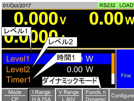
ダイナミックモードでロードオンのとき、トリガ出力 BNC 端子からパルス信号が出力されます。
