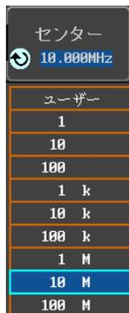
4. ユーザー設定を選択すると編集ダイアログと矢印が表示されます。桁を矢印キーで選択、Variable ツマミで値を変更し Select キーで設定します。
