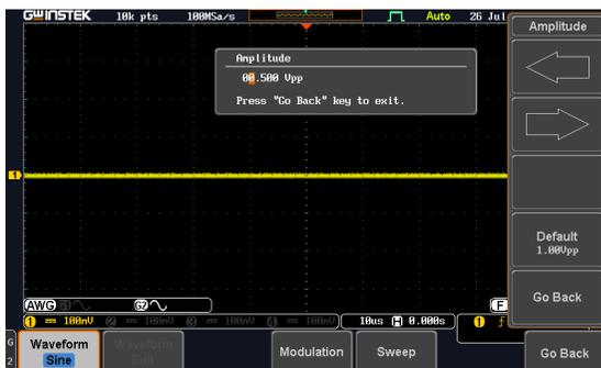
4. 左右のキーで桁を移動し、Variable ツマミで値を変更します。
