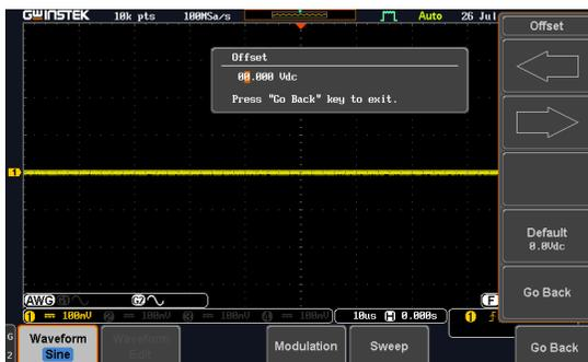
8. 左右のキーで桁を移動し、Variable ツマミで値を変更します。
