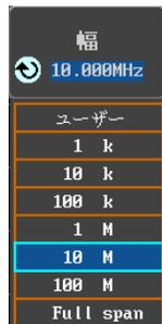
2. ユーザー設定を選択すると編集ダイアログと矢印が表示されます。桁を矢印キーで選択、Variable ツマミで値を変更し Select キーで設定します。
