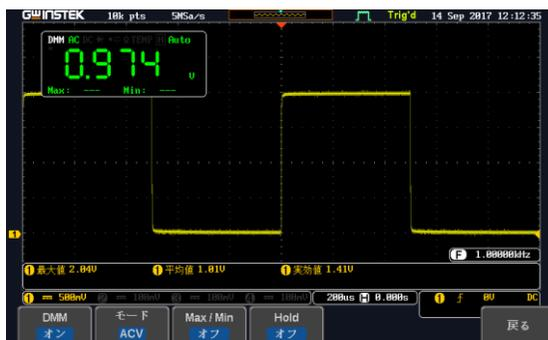
3. 下部メニューの DMM キーを押すと DMM 機能のオン・オフができます。モードキーを押すとモード選択メニューが右側に表示されます。
