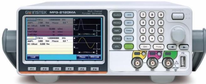
MFG シリーズをはじめとする一般的なファンクションジェネレータの出力は、電圧として信号を出力し、また 100mA 以下の電流しか流すことができない為 (50Ω伝送機器, ±5Vpk 出力 max)、LED を点灯させるには不十分な場合があります。ここでは、MFG シリーズの内蔵アンプに信号を通すことで、ファンクションジェネレータの出力信号で 100mA 以上の電流を流して LED を点灯させる手順を簡単に説明します。
