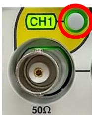
OUTPUT ON で信号を出力し、LED 回路へ信号を供給します。
