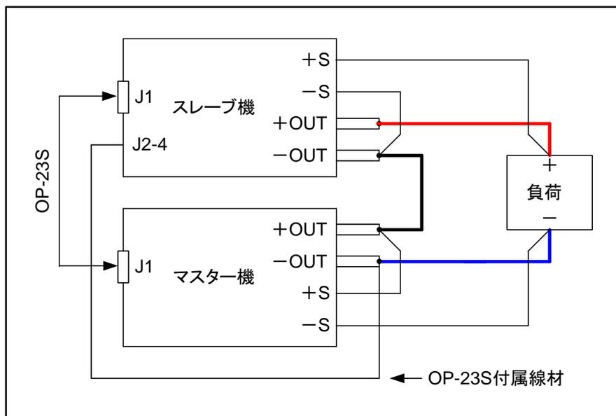
1. マスター機の正出力端子とスレーブ機の負出力端子を接続し、マスター機の負出力端子を負荷マイナス側へ接続します。スレーブ機の正出力端子を負荷プラス側へ接続します。
