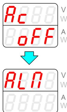
電源スイッチ OFF 操作なしで電圧電流表示部に“AC OFF”→“AL Π”と表示されると、本器故障が原因で発生している可能性があります。その場合は、以下の操作をおこなってください。
