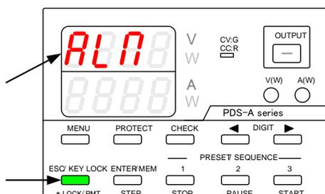
電圧表示部に“AL Π”が表示され、ESC KEY 緑点灯となる場合は、緑点灯している ESC KEY を押すと電源操作可能状態となります。
