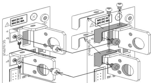
正および負背面出力端子と正および負電圧リモートセンシング端子に取付けられている M3 ネジ(4 本)を外し、正および負ショートバーを外してください。
