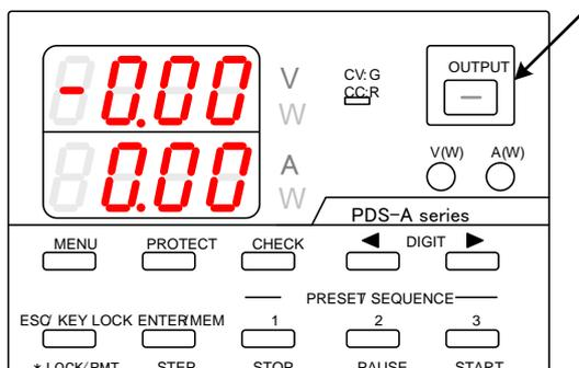
本器は、アナログ IF の外部接点による OUTPUT ON/OFF 操作中の OUTPUT ON 時に、フロントパネルの OUTPUT KEY から、OUTPUT ON/OFF 操作ができます。
