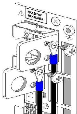
接地用ケーブルは背面出力端子の M3 穴に、背面出力端子左側から取付けてください。
