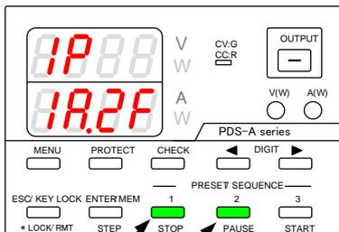
自動 IP アドレスまたは固定 IP アドレスの入力選択画面が左図の様に表示されます。電流表示部は 1:Auto(自動)、2:Fix(固定) となり点滅しているキーを押します。
