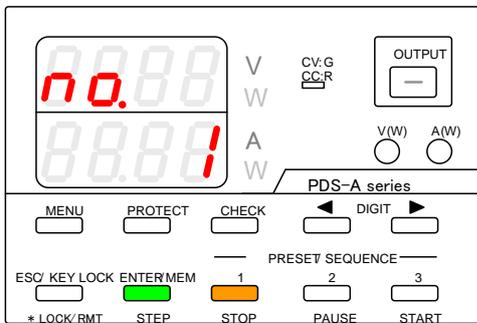
シーケンスプログラム実行停止状態となると、停止した STEP が OUTPUT ON 設定でも、OUTPUT OFF となります。シーケンスプログラム実行停止後は、停止した STEP からのシーケンスプログラムの実行開始はできません。
