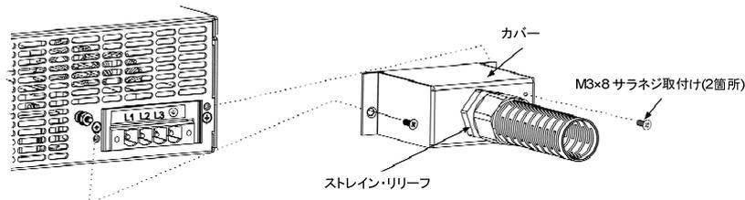
図 2-6 AC 入力カバーの取付け
