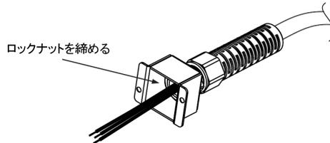
図 2-4 ストレインリリーフへの AC ケーブル取付け
