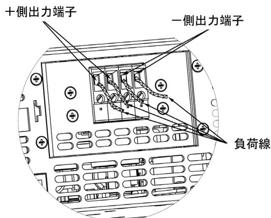
図 2-20 出力端子への負荷線の接続
