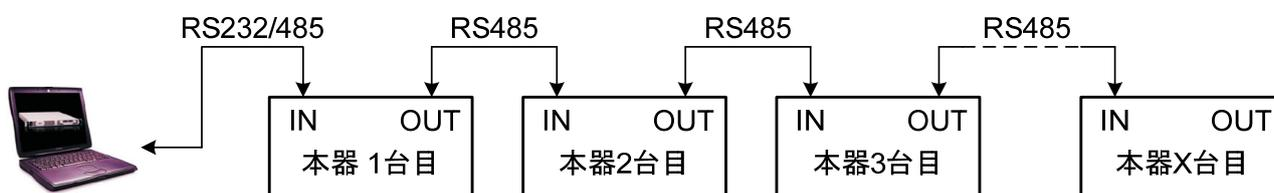
図 6-5 RS232/485 接続による複数台の接続
