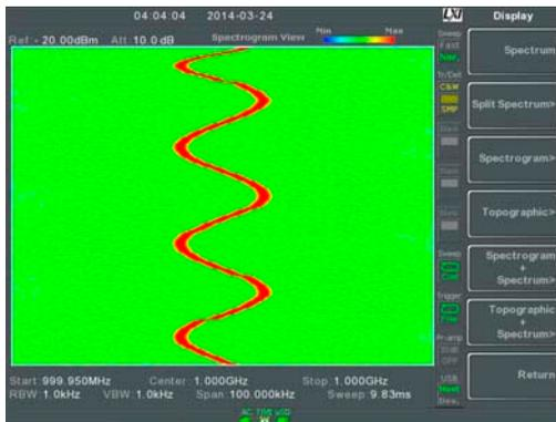
スペクトログラム表示は、周波数ドメインと時間ドメインの両方における信号を表示します。X軸は周波数、Y軸は時間を表示し、各ポイントの色は、特定の周波数と時間における振幅を表示します(赤色=レベルが高い、濃い青色=レベルが低い)。
