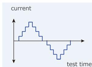
センシングテストとして電流値や極性を替えて電流を流し、シャント抵抗電圧と比較し定格評価することができます。
