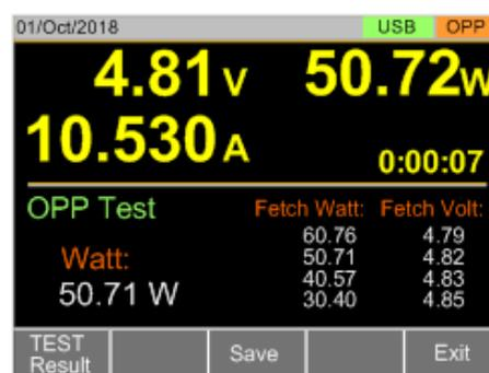
電源装置の過電力保護動作の確認が自動で可能なOPPテスト
