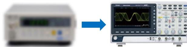
20MHzの帯域制限（アナログフィルタ）は安価なオシロで多く搭載されていますが、100MHzの帯域制限が搭載されているのは、高価なモデルばかり！
