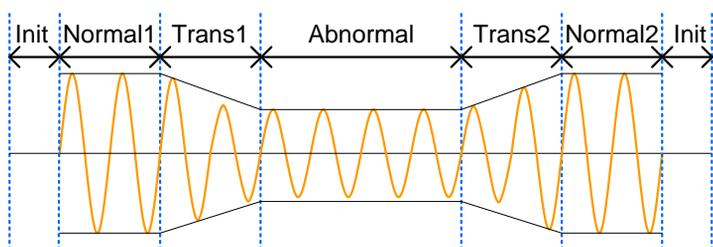
6つのステップを設定するだけで、簡単にシミュレーション試験ができます。
