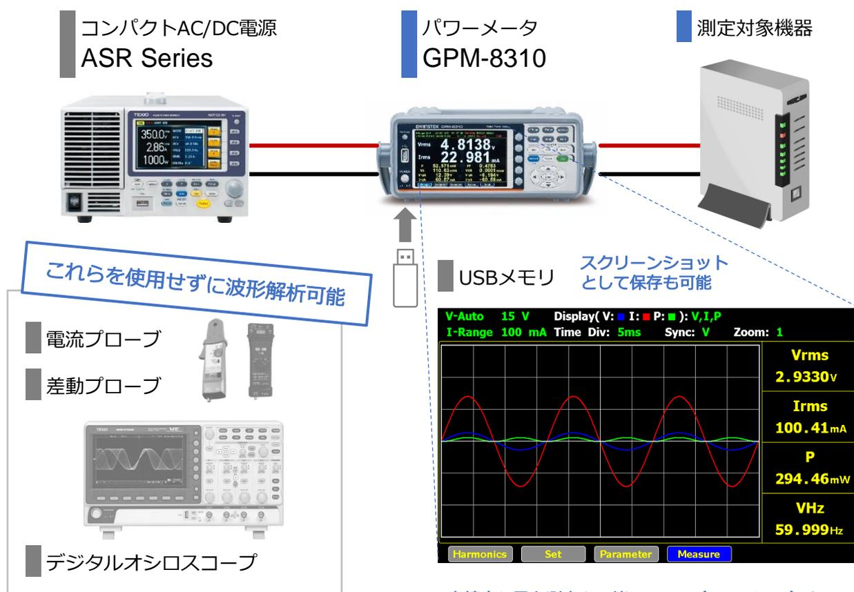
高精度な電力測定と一緒にGraph (Waveform) を表示することが可能。
